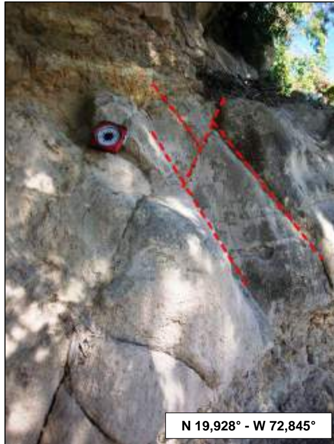
Illustration 38 : Fractures normales conjuguées N 80° E - 50° S et N 76° E - 60° N affectant les turbidites.
