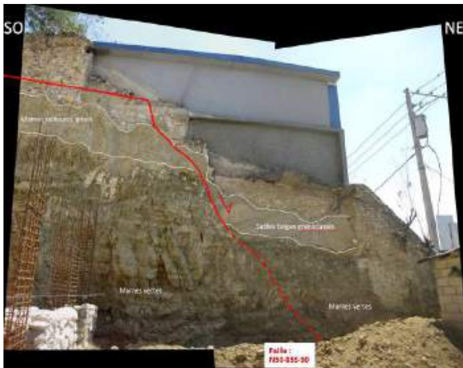
Figure 39 - Failles normales quaternaires, de direction NE-SW, visibles au quartier Demas 28 (station 3) : Vue de l’affleurement extrémité SE, Faille normale sub parallèle au plan de coupe
