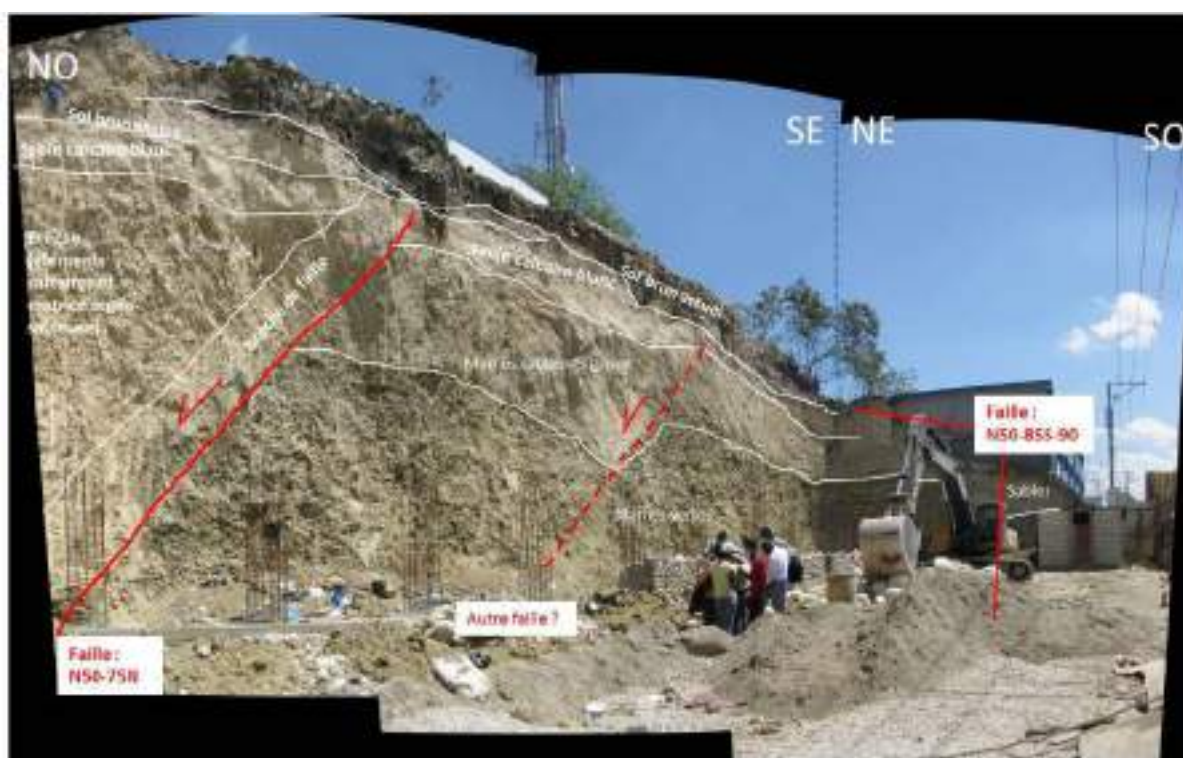
Figure 38 - Failles normales quaternaires, de direction NE-SW, visibles au quartier Demas 28 (station 3) : Vue de l'ensemble de l'affleurement
